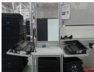
Figura 7 - Bancada de inspeção visual na linha de produção das lentes B299 (molde 094.1)
